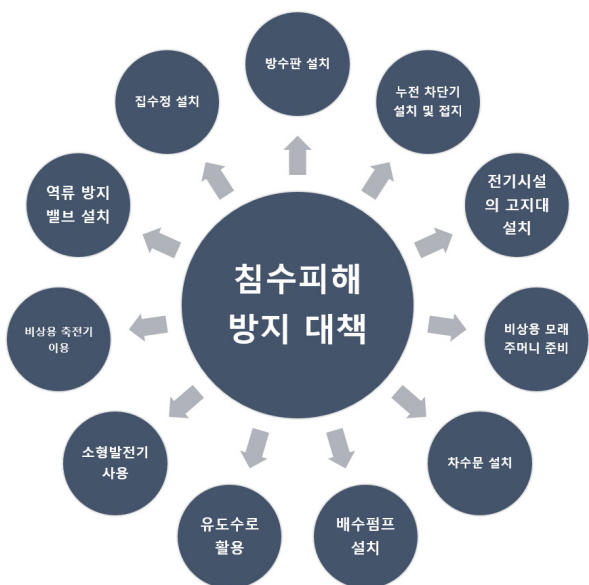
그림 6 수방기준에 의한 침수사고의 방지대책
